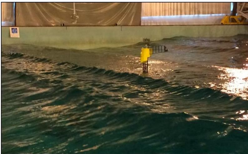
**Ci-contre** : Le modèle réduit de Polar POD en essais dans le bassin de l'ECN (situation de houle irrégulière).
