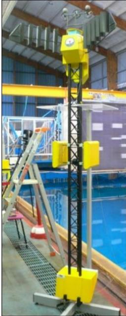
Le modèle réduit, d'une hauteur de 2,5 m environ (échelle 1/41)
