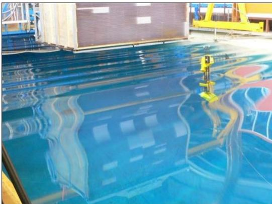
Modèle réduit de Polar POD subissant les vagues créées par le générateur de houle.
